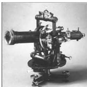
Teodolito Salmoiraghi, usado por Gago Coutinho na Missão Geodésica da África Oriental (1907-1910) e Missão Geodésica de S. Tomé e Príncipe (1916-1918)
